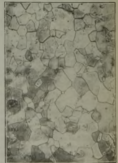
Abbildung 26. Vollständige Rekristallisation nach Warmstauchung und Glühung bei 800° während 2 st.
