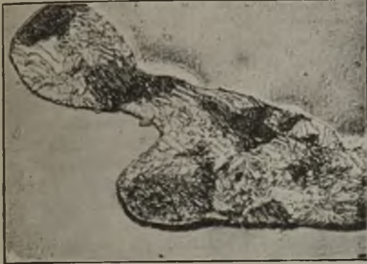
Abbildung 5. Perlit, in Entmischung begriffen.
