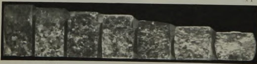
Abbildung 11. Korn im Längsschnitt der Stauchkörper aus Stahl für Transformatorenbleche.
