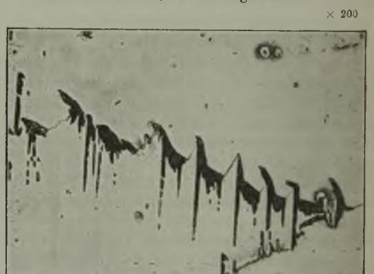
Abbildung 4. Perlit in Widmannstättenscher Struktur nach einer Glühung bei 1200°.
