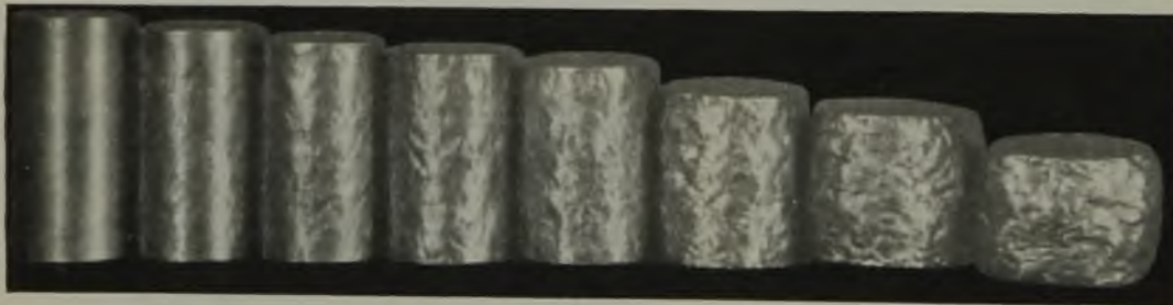
Abbildung 10. Stauchkörper aus Stahl für Transformatorenbleche.
