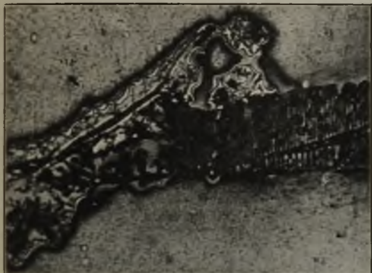
Abbildung 9. Uebergang eines Steaditbandes in eine Graphitader, mit alkalischer Natriumpikratlösung geätzt.
