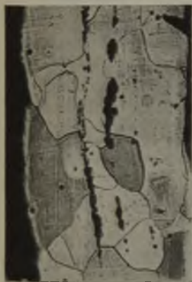
Abbildung 1. Schlackenzeilen im Transformatorenblech.
