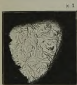
Abbildung 5. Probe aus einer Ofensau, ungeätzt.
