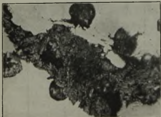
Abbildung 14. Aufbau einer Graphitlamelle, ungeätzt.
