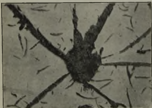
Abbildung 13. Keimwirkung bei der Kristallisation des Primärgraphits, ungeätzt.
