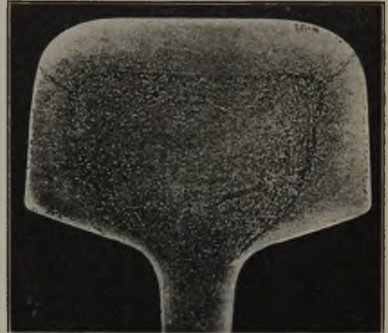
Abbildung 23. Rißfreie Schiene mit Spuren verschweißter Randblasen und Transkristallisationsdiagonalen der Blockkanten.
