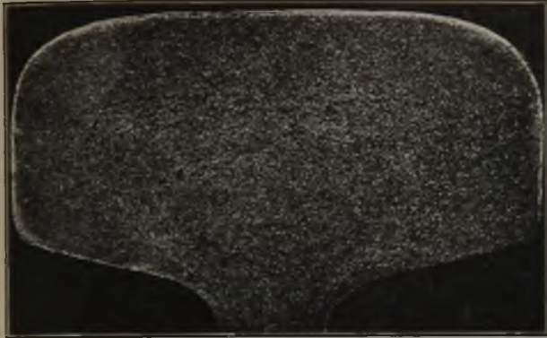
Abbildung 21. Feinkörnige Oberflächenkruste in einem Schienenkopf.
