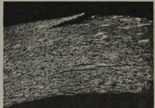
Abbildung 15. Oberflächenfehler infolge von Randblasenseigerung in siliziertem Röhrenstahl.
