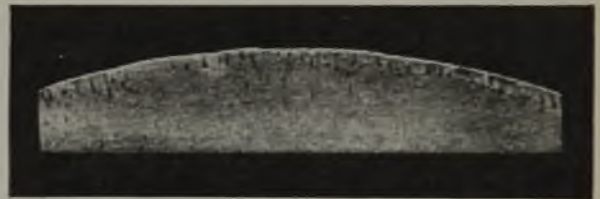
Abbildung 14. Spuren verschweißter Randblasen in siliziertem Stahl.
