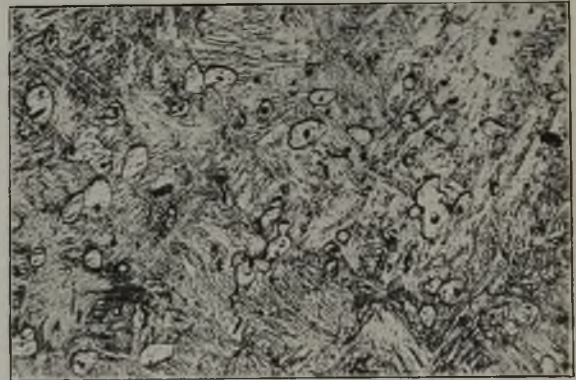
Abbildung 6. 5 min auf 1100°; gehärtet in Wasser.
