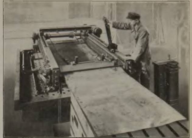
Abbildung 5. Aufreißmaschine für Feinbleche.
