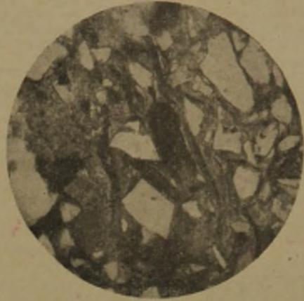
Abb. 3. Tonstein über dem Traugott-Flöz, Höhe 330,3 bei Birkental. Dünnschliff, Vergr. 30 $\times$ . Quarz- und Feldspatsplitter (weiß) und Biotitblätter (dunkel) in einer tonigen Grundmasse. Unter der Bildmitte ein glasklares Feldspatkorn; links davon gekrümmter Leverrierit (grau).
