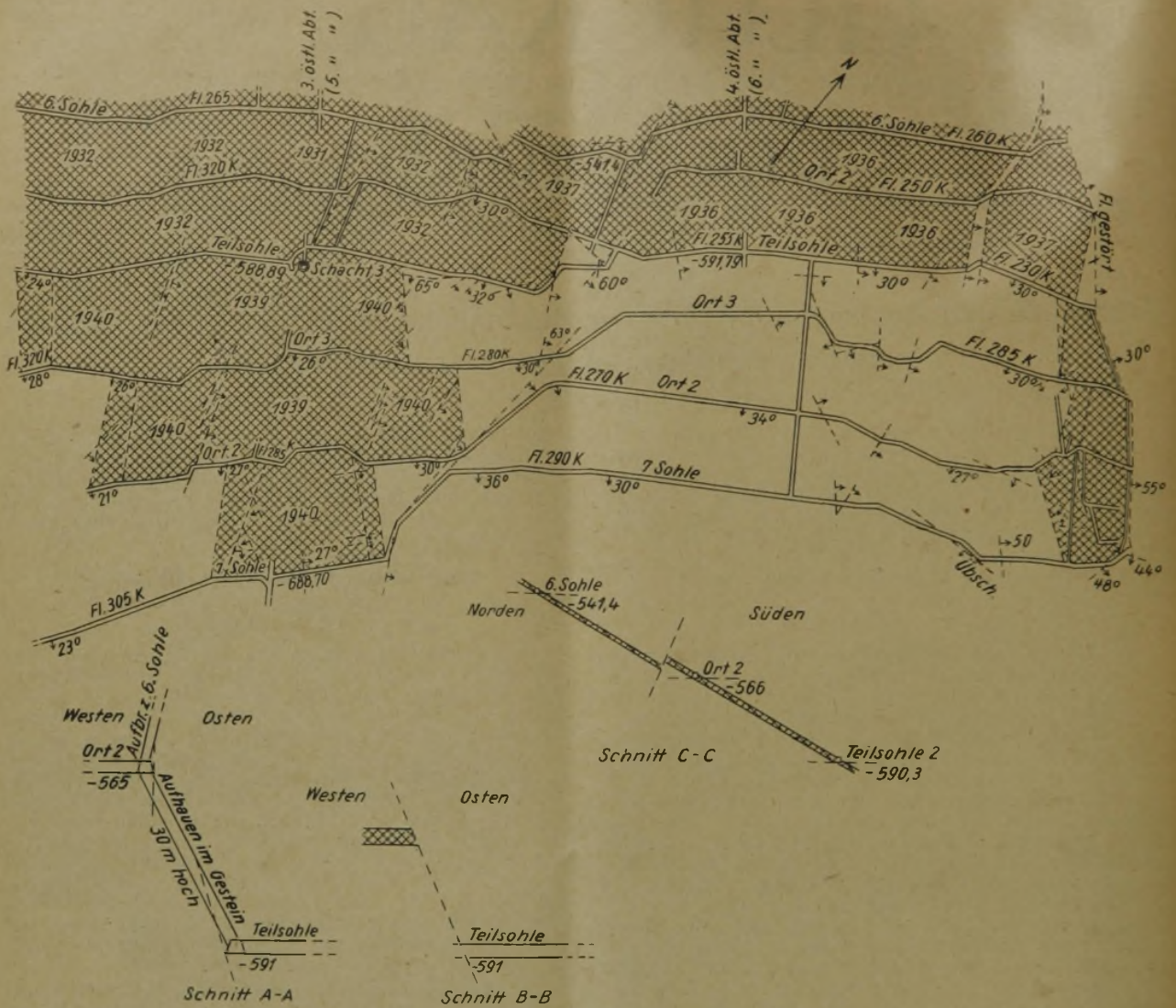
Abb. 1. Gesamtübersichtsflozriß des Flözes Dickebank.
