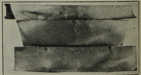
Abbildung 5. Prüfung auf Härtefähigkeit.
