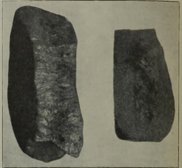
Abbildung 1. Kristallines und „steiniges“ Bruchgefüge zweier Schlacken.
