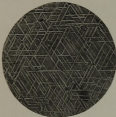
Abbildung 4. \times 200 Hämatit (weiß), längs den Oktaederflächen von Magnetit. Handelssinter der Reading Iron Co.
