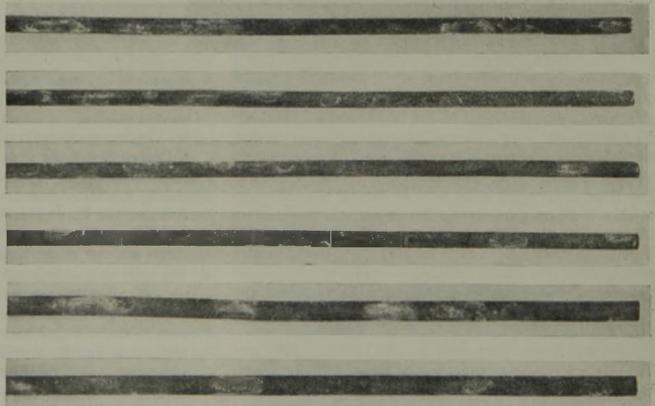
Abbildung 1. Weißer Zinkrost bei Drähten.
