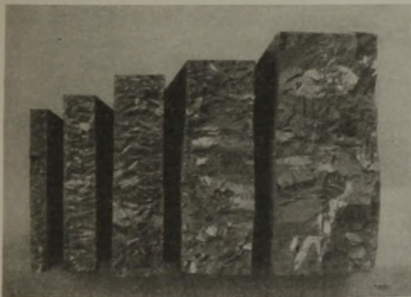
Abbildung 54. Abhängigkeit der Korngröße von den Wandstärken. (Bruchgefüge von FF 25 im Gußzustand.)
