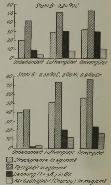
Abbildung 42. Einfluß der Wärmebehandlung auf die Festigkeitseigenschaften von Stahlguß (Probstücke 40 mm □).
