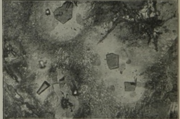
Geätzt mit dem Sulfid-Aetzmittel von Künkele.
