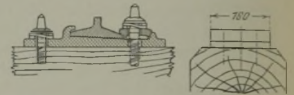
Abbildung 2. Preußisch-hessischer Oberbau 15c auf Holzschwellen.
