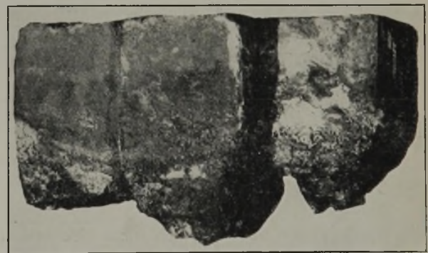
Abbildung 6. Aussehen der Siliziumkarbidsteine nach dem Versuch.
