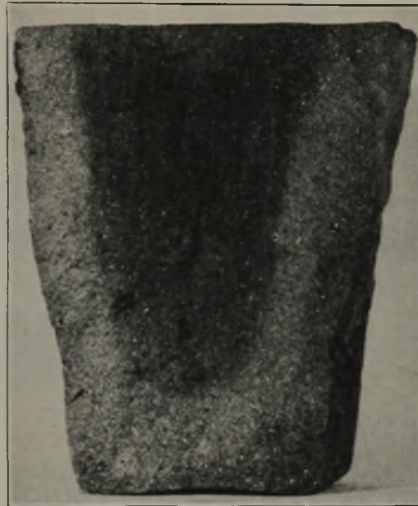
Abbildung 9. Bruchfläche und Zonenbildung eines fehlerhaften SiC-Steines.
