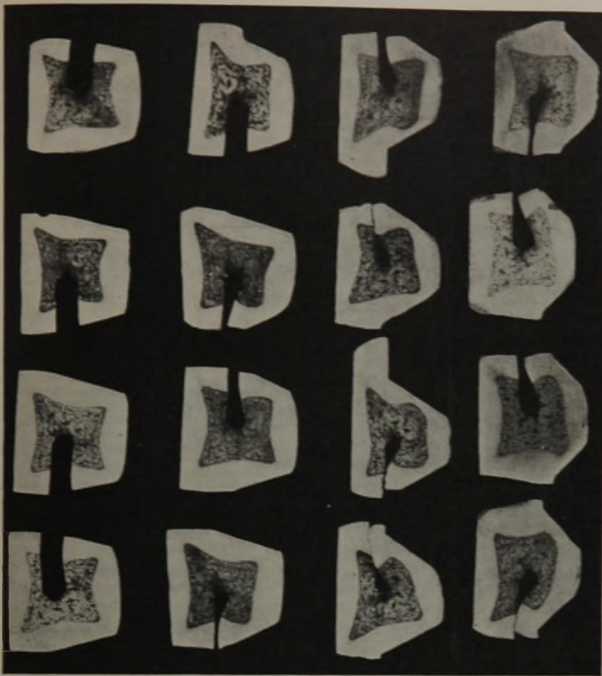
Abbildung 24. Schliffbilder der Schlagproben.
