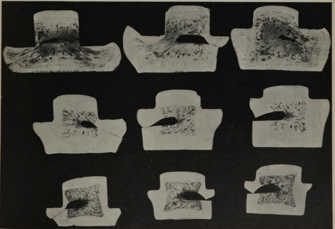
Abbildung 21. Schliffbilder der Schlagproben.
