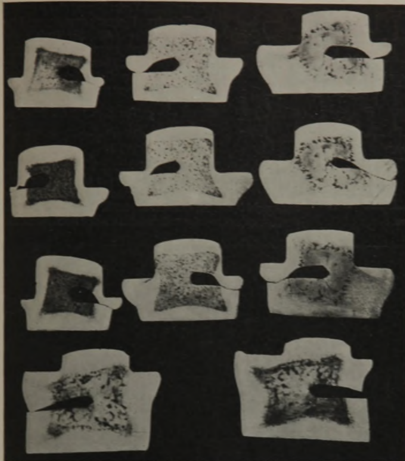
Abbildung 22. Schlibbilder der Schlagproben.
