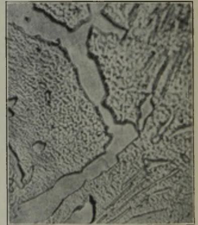
Abbildung 8. Uebereutektoide Zone eines Stahles mit Gefügeanomalität (nach O. E. Harder und W. S. Johnson).
