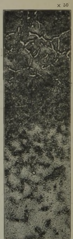
Abbildung 5. Stahl mit Gefügeanomalität, 6 h bei 940° zementiert.
