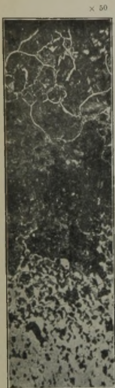
Abbildung 1. Normaler Stahl 6 h bei 940° zementiert.
