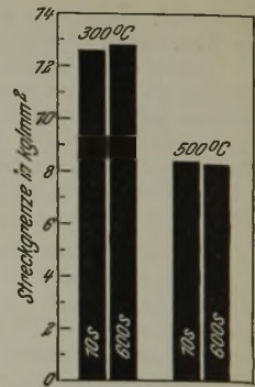
Abbildung 3. Einfluß der Wartezeit nach der Entlastung auf die Lage der Streckgrenze.
