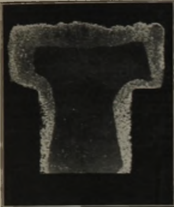
Abbildung 1. Bolzenkopf mit interkristalliner Korrosion. (Längsschliff.)
