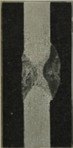
Abbildung 31. Kornvergrößerung an der Schweißnaht eines autogen geschweißten Bleches aus halbferritischem Stahl (0,3 % C, 18 % Cr) von 6 mm Stärke.
