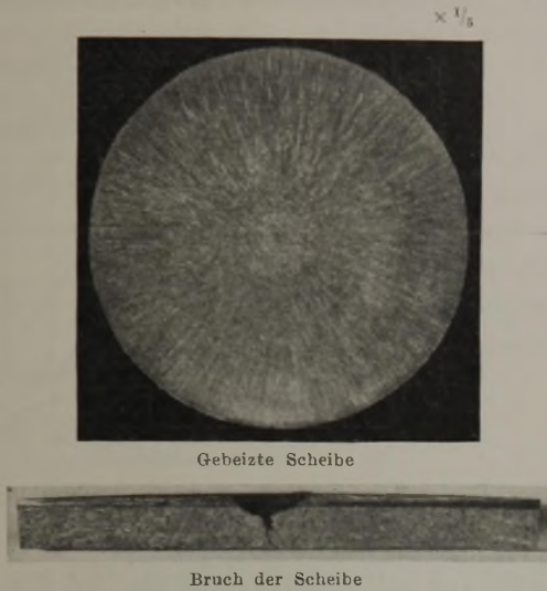
Abbildung 8. Scheibe aus dem Gußblock eines martensitischen Stahles.
