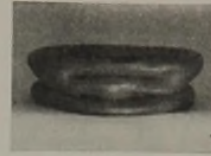
Rohr 45 mm Dmr., 2 mm Stärke
