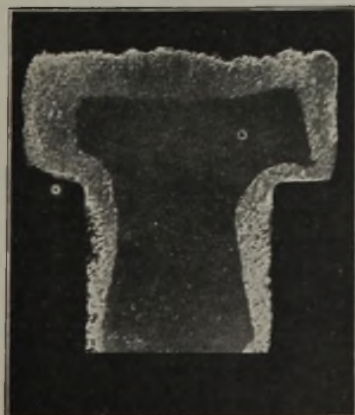
Abbildung 36. Interkristalline Korrosion an Stücken aus austenitischem Stahl.
