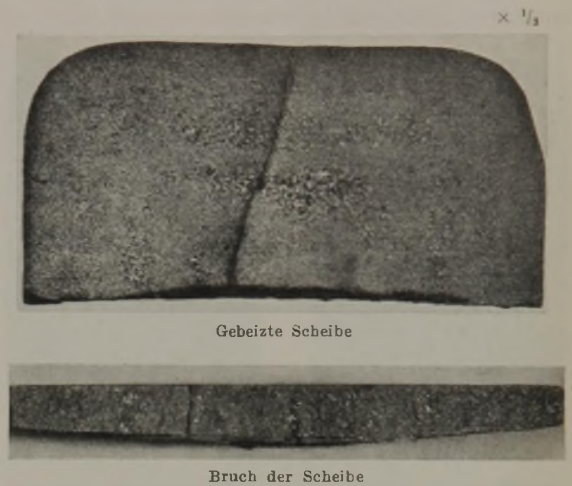
Abbildung 10. Scheibe aus einem Gußblock des ferritischen Stahles (0,3 % C und 30 % Cr).
