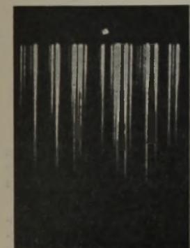
Abbildung 1. Teil eines Spektrums, aufgenommen mit dem logarithmischen Sektor.
