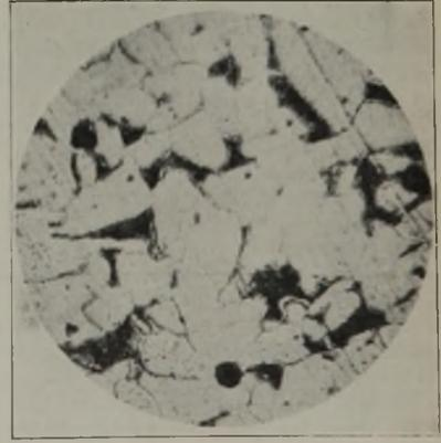
Abbildung 2. Schweißversuche an nitriertem Weicheisen.
