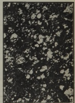
Abbildung 16. Vorgeschmiedet. Abbildung 17. Gewalzt. Abbildung 16 und 17. Gefüge eines richtig verarbeiteten Stahles mit 0,96% C und 13,96% Cr. (Aetzung mit Königswasser.)
