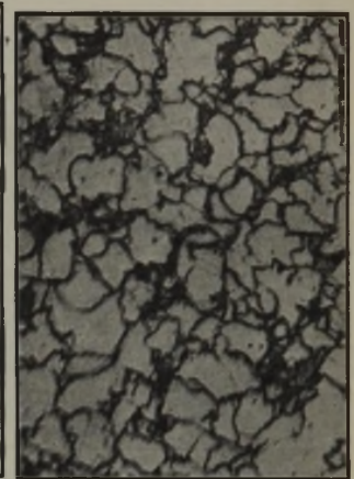
Abbildung 14. Blockrand. Abbildung 15. Blockmitte. Abbildung 14 und 15. Gefügeunterschiede zwischen Rand und Mitte eines schlecht verwalzbaren Knüppels mit 0,96% C und 13,96% Cr.
