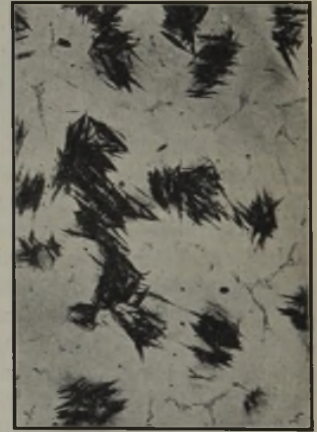
Abbildung 5. Abgeschreckt von 1200°. (Aetzung mit Natriumpikrat.)
