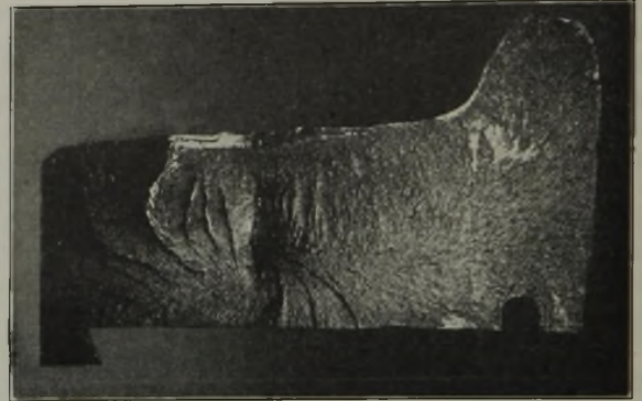
Abbildung 1. Aussehen der Brüche bei Radreifen 6 und 7.
