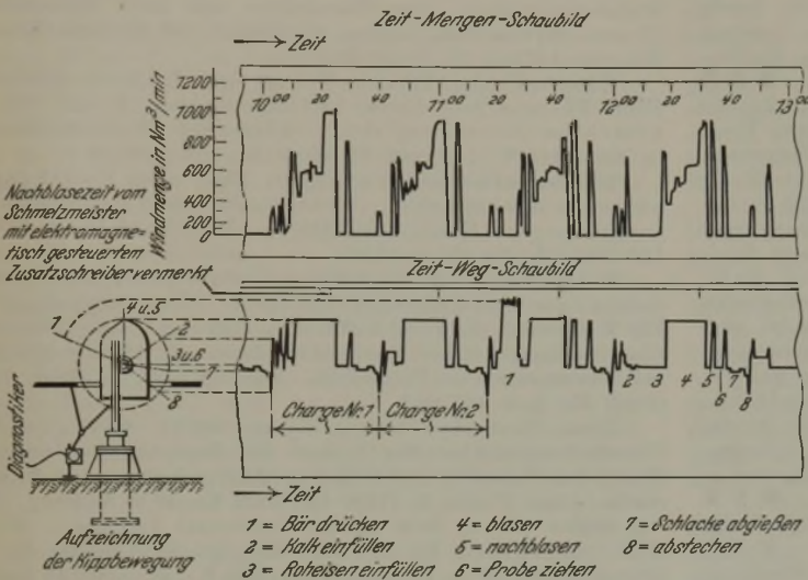
Abbildung 1. Betriebsüberwachung eines Thomaskonverters mit Diagnostiker und Windmengenmesser.
