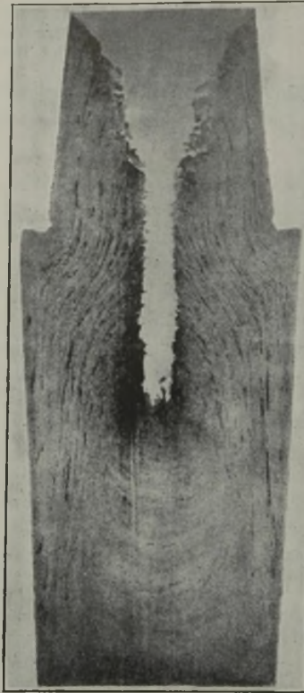
Abbildung 2. Schwefelabdruck des Versuchsblockes.
