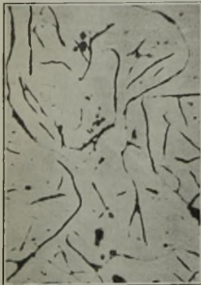
Stab 1 (mit 0,23 % Mo) Stab 3 (ohne Zusatz) Abbildung 1. Schliffbilder der Probestäbe mit und ohne Molybdänzusatz.
