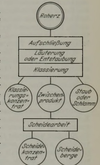
Abbildung 1. Grundsätzlicher Stammbaum der gegliederten Aufbereitung für die untersuchten konglomeratischen Eisenerze.
