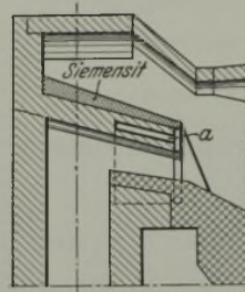
Abbildung 1. Ausführung der Brennerzunge mit Kühlrahmen.
