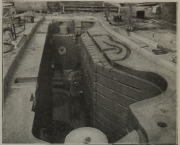
Abbildung 3. Gießform ohne Kern für eine Seitenwange des Oberholms.
