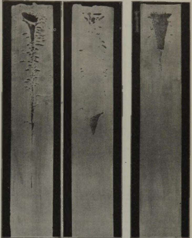
Abbildung 2 a. Fehlerhafte Blöcke.
