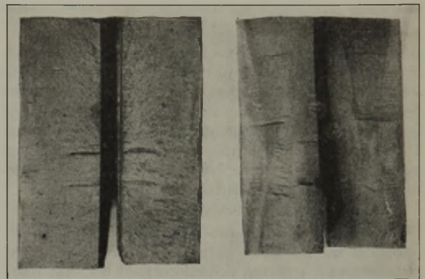
Abbildung 3. Härtebruchproben beim Schnelldrehstahl.
