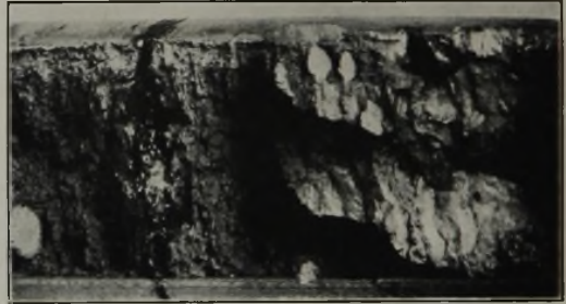
Abbildungen 14 bis 17. VCN 35-Blöcke in Kühlform vergossen, zweifach verschmiedet, an Luft abgekühlt.
