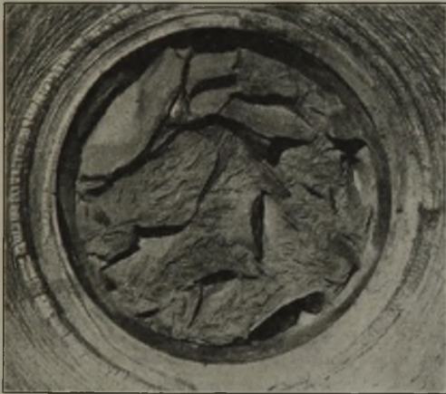
Abbildung 51. Grobe Flocken in einer an Luft erkalteten geschmiedeten Welle von 500 mm Dmr.
