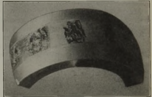
Abbildung 32. Wirkung der Laufbahnbeschädigung.
