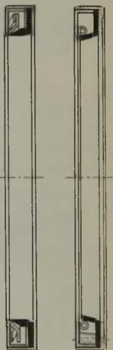
Abbildung 11. Lederring- Abdichtung für Kegelrollenlager.
