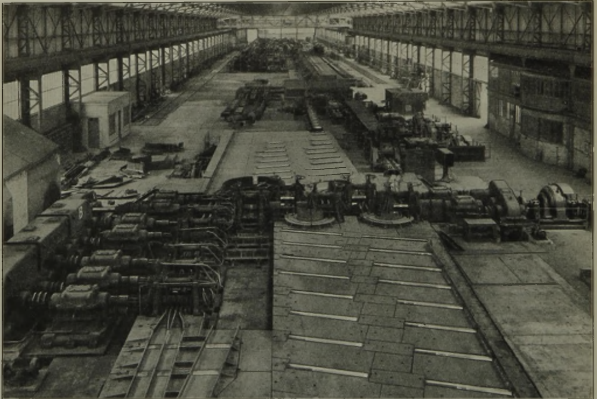
Abbildung 3. Feinstahl- und Drahtwalzwerk eingerichtet zum Walzen von Draht.
