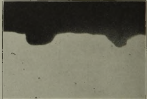
Abbildung 28. Schliff durch einen mit Backenkratzern behafteten 30-mm-Rundstab.
