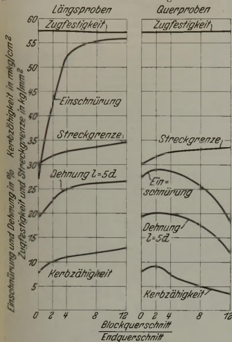
Abbildung 6. Einfluß der Verschmiedung auf die Festigkeitseigenschaften in der Längs- und Querfaser eines Stahles mit 0,35 % C. (Ausgangsgröße des Blockes 440 mm □, 3 t.)
