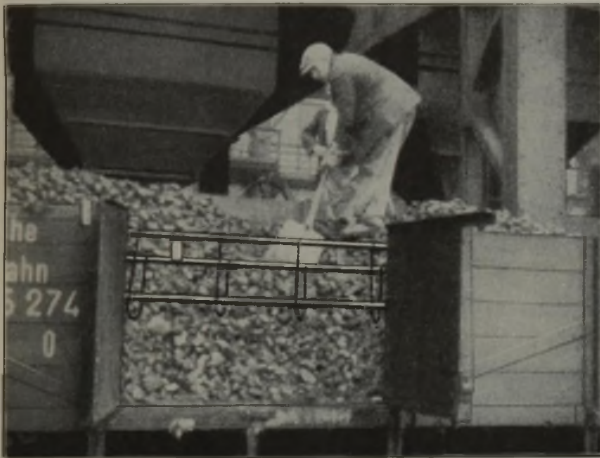
Abbildung 2. Vorrichtung zur Verhinderung des Abrutschens beim Entladen von Eisenbahnwagen.
