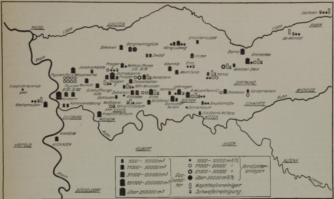
Abbildung 2. Größe und Lage der Verdichteranlagen, Reiniger und Gasbehälter.
