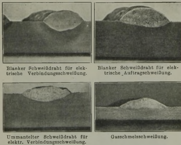
Abbildung 5. Einbrände bei verschiedenen Schweißstäben und verschiedenen Schweißverfahren.
