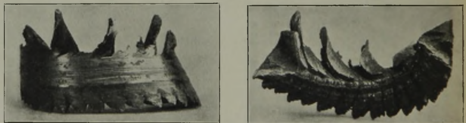
Abbildung 15. Schwerer Hobelspan von 295 g Gewicht.
