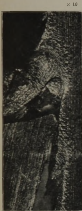
Abbildung 3. Siemens-Martin-Stahl; \sigma_B = 41 \text{ kg/mm}^2 ; H = 114 \text{ kg/mm}^2 ; Stahl mit Hohlkehle; Stillstand; b = 3 \text{ mm} ; t = 0,8 \text{ mm} .
