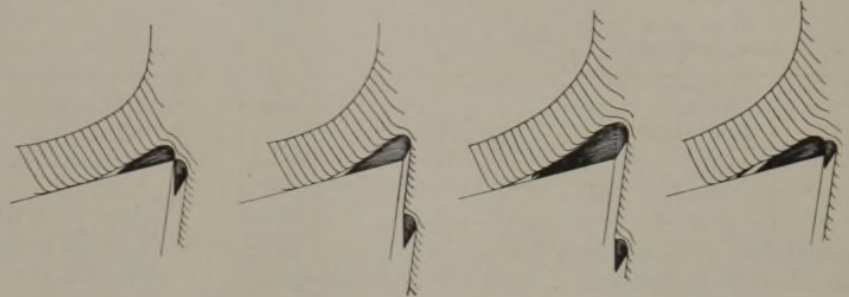
Abbildung 22. Zu- und Abnahme des Schneidansatzes.
