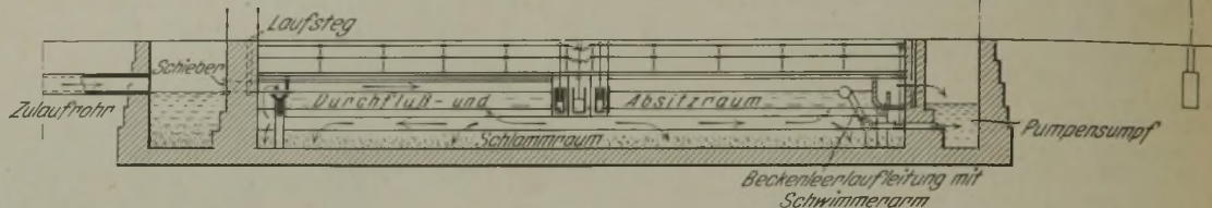
Abbildung 1. Querschnitt durch das Klärbecken für Walzwerksabwasser.
