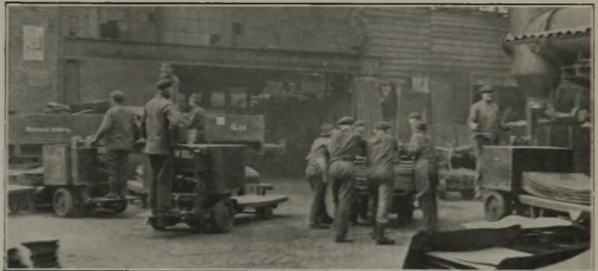
Abbildung 5. Elektrohubkarren mit Ladebank für Feinbleche. Bauart A. E. G.
