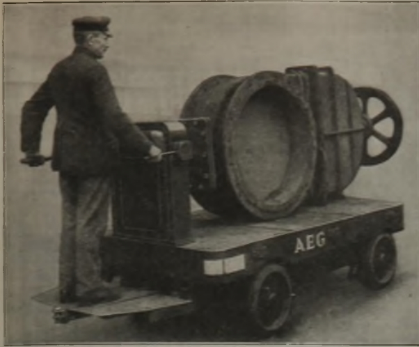
Abbildung 4. Elektrokarren mit fester Plattform für 2500 kg Tragkraft. Bauart A. E. G.
