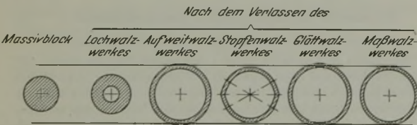
Abbildung 2. Flock- und Rohrquerschnitte beim Automatic-Rohrwalzverfahren.
