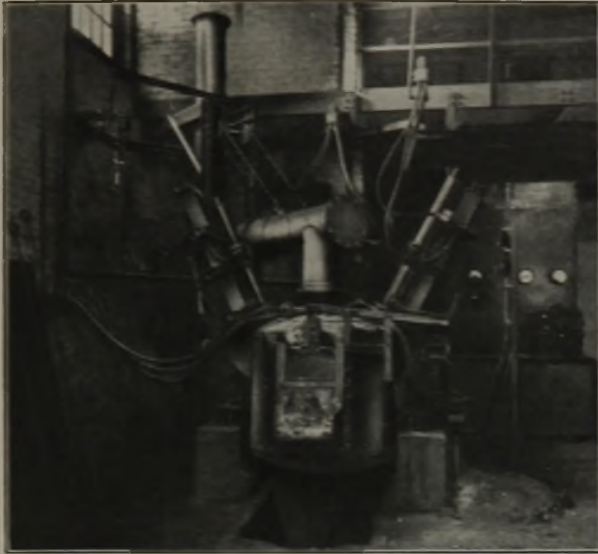
Abbildung 3. Klein-Elektroofen in Betriebsstellung.
