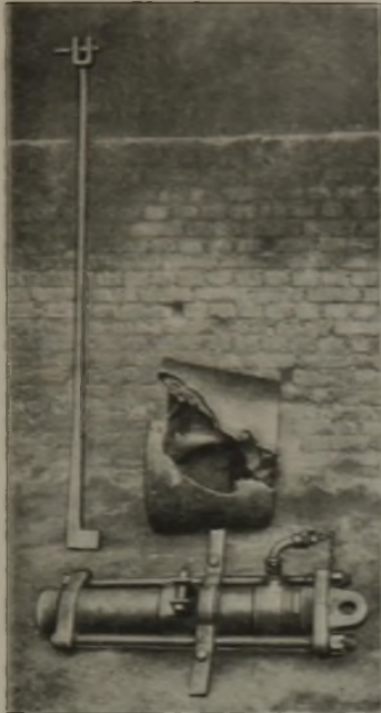
Abbildung 2. Mit dem Stichlochhammer innerhalb 5 min herausgezogene Blasform mit Schutzkasten.
