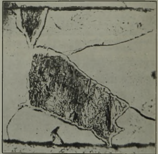
Abbildung 11. Aufkohlung eines Elektrolyteisenbleches (siehe Abb. 10).
