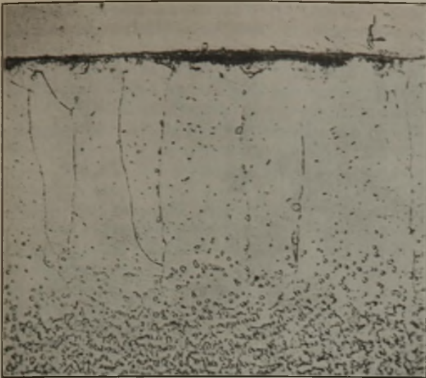
Abbildung 17. Stahl Nr. 6 mit 1,2 % C, 168 min bei 685° in feuchtem Wasserstoff entkohlt.
