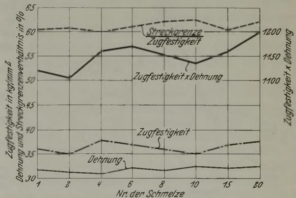
Abbildung 3. Festigkeitseigenschaften der mit verschiedenen Titanzusätzen hergestellten Schmelzen einer kupferhaltigen Schmelze (Nr. 1). Längsproben.
