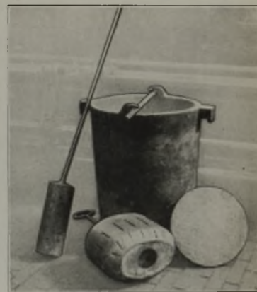
Abbildung 1. Tiegel aus Stahlguß mit Deckel und Tauchglocken.
