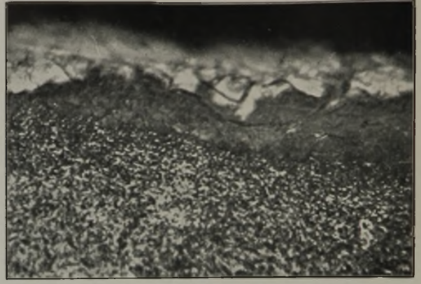
Abbildung 18. Randzone an der Oberfläche einer Reibstelle im Längsschliff.
