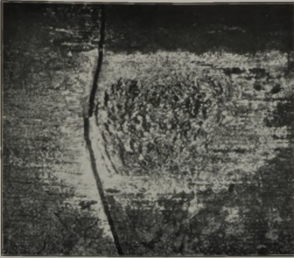
Abbildung 6. Reibstelle eines Federblattes aus Siliziumstahl mit Dauerbruchausgang.
