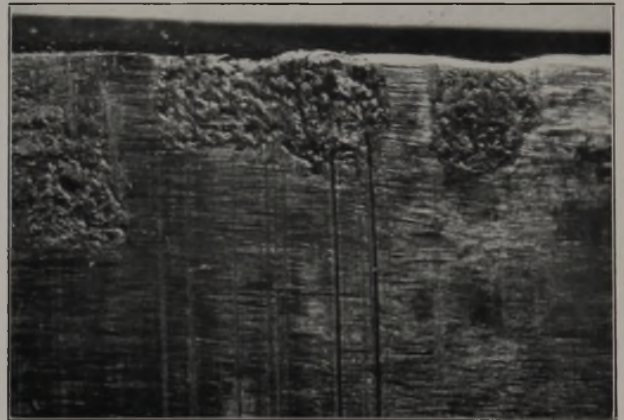
Abbildung 15. Oberfläche am Bruchausgang B nach Abb. 14 mit Fressungen.
