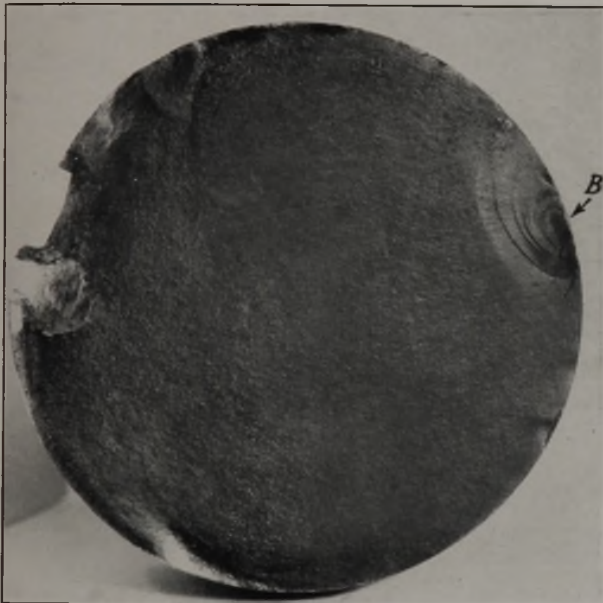
Abbildung 14. Dauerbruch einer Turbokompressorwelle aus Chrom-Nickel-Stahl.
